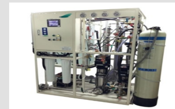
純水製造装置
